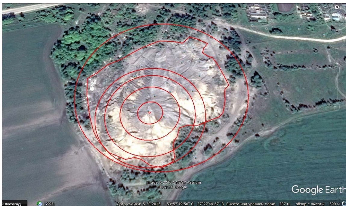
Рис. 2. Построение контура породного отвала шахты Западно-Щекинская 17-бис и определение координат и высот точек поверхности
