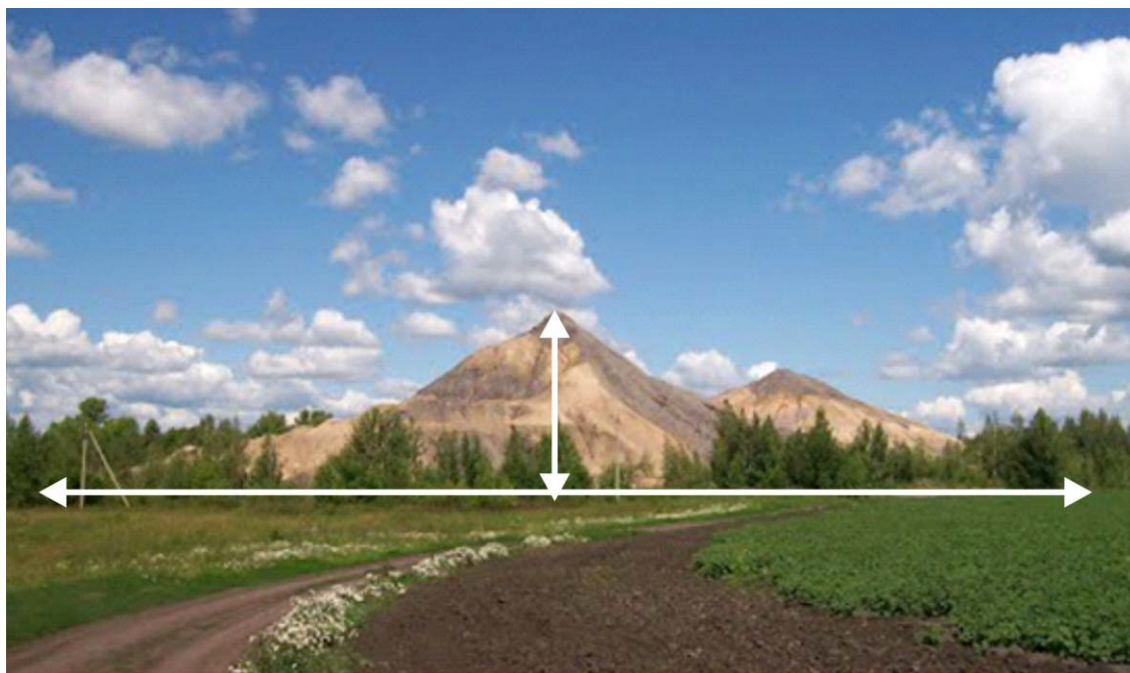
Рис. 3. Боковой снимок отвала шахты Западно-Щекинская 17-бис с измерениями для расчета коэффициента масштабирования
